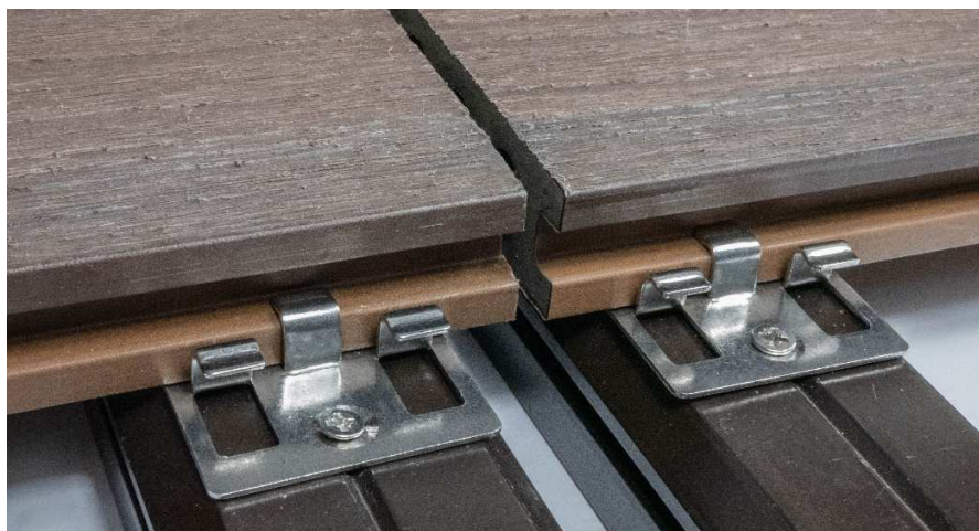
Rysunek 16. Połączenie czołowe desek na dwóch oddzielnych legarach (dylatacja 1 cm)
