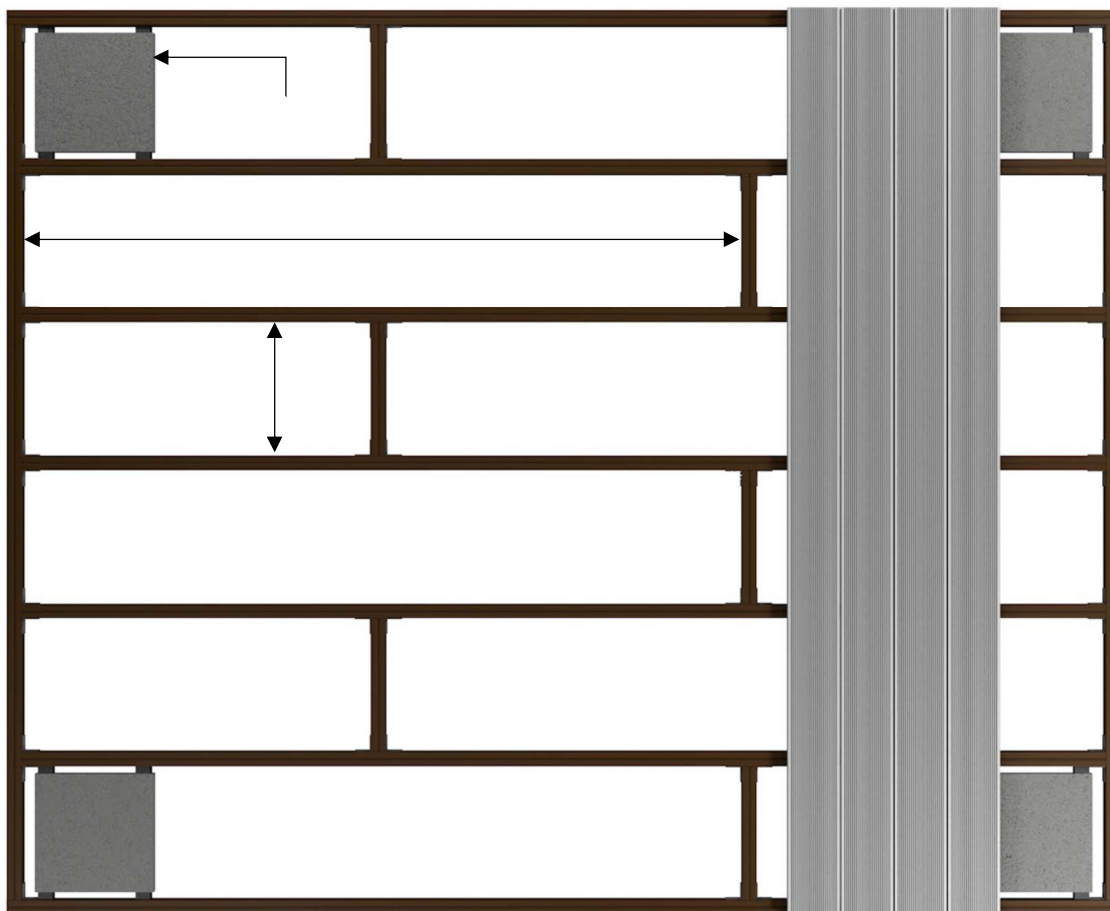
Rysunek 7. Taras plywający - rama z legarów połączona kątowymi łącznikami ciesielskimi, obciążona płytami betonowymi
