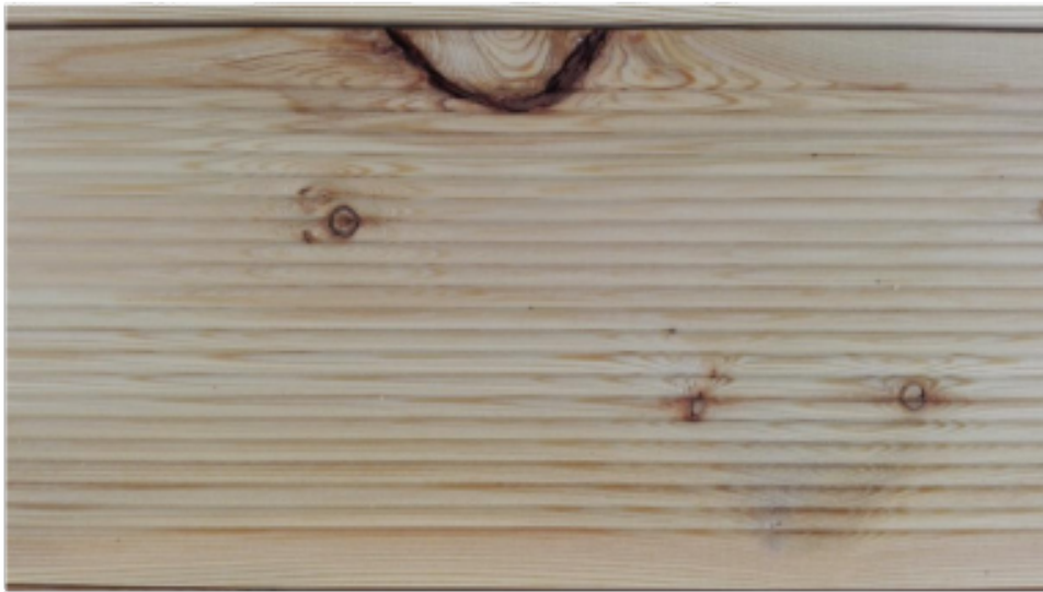
Fot. 1 - boczny sęk z wrośniętą korą
