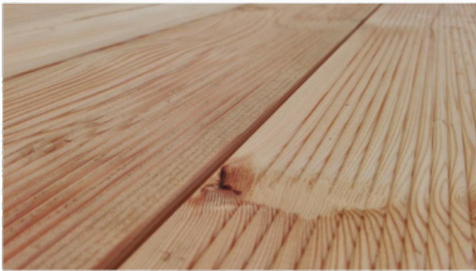
Fot. 10 - element wyrwany podczas strugania
