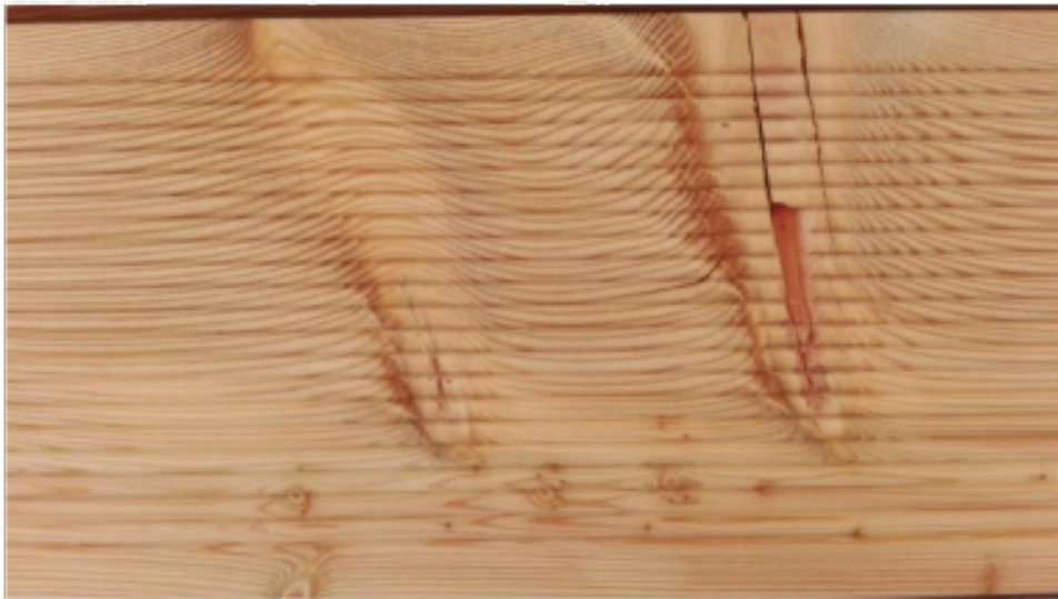
Fot. 5 - sęk skrzydlaty w części wypadnięty
