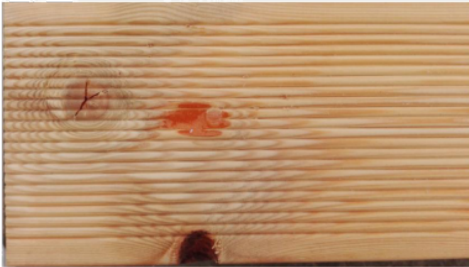
Fot. 3 - wypadnięty sęk i poprzeczna komora żywiczna
