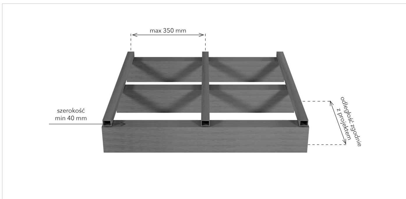
Rys 3. Legary na konstrukcji stalowej
